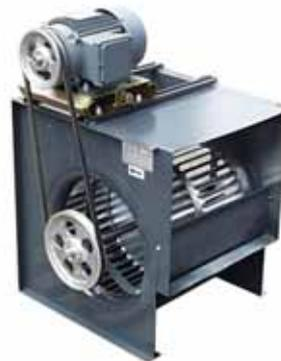
*Volute :* Acier galvanisé. Version cubique du VP180 au VP500, ceinture à bords tombés, ouïe aspiration rapportée dans le flanc soudé par point
